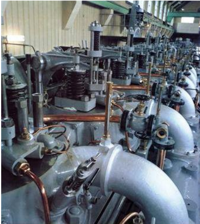
Zicht op de top, cilinderkoppen, van de Werkspoormotoren
